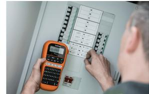
Das Brother P-touch E110 ist ein leichtes und tragbares Beschriftungsgerät, ausgestattet mit verschiedenen Funktionen zur einfachen Erstellung häufig verwendeter Etikettentypen, z. B. für Kabel oder Anschlüsse. Das Modell ist mit einer QWERTZ-Tastatur ausgestattet.
